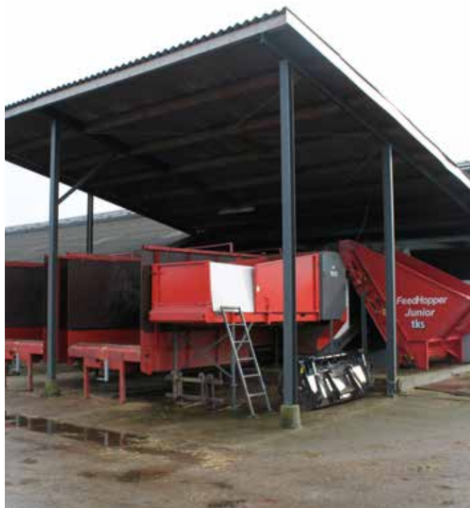
De voerbunkers van het voersysteem. Van Loon beschikt over twee bunkers van 32 m 2 . Daar zet hij blokken kuilvoer in. Voor losgestorte producten heeft hij een bunker van 5 m 2 . Een vierde bunker kan stro en balen verwerken.
