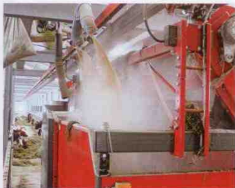
De verschillende voersoorten worden laagsgewijs in de bak geplaatst en afgewogen met weegcellen in het ophangwerk.
