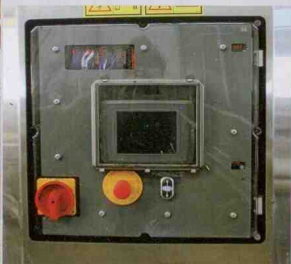
De voorzijde van de robot met de stopknop en het touchscreen achter de plastic kap.
