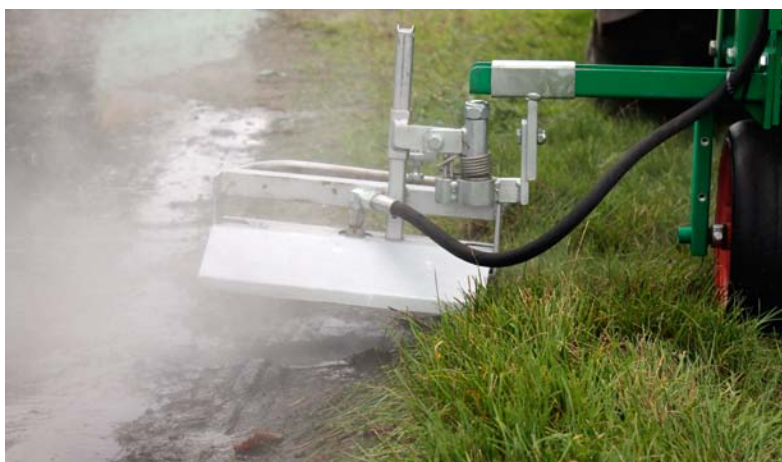
Bijna kokend water zorgt ervoor dat cellen van onkruidplantjes kapotbarsten.
