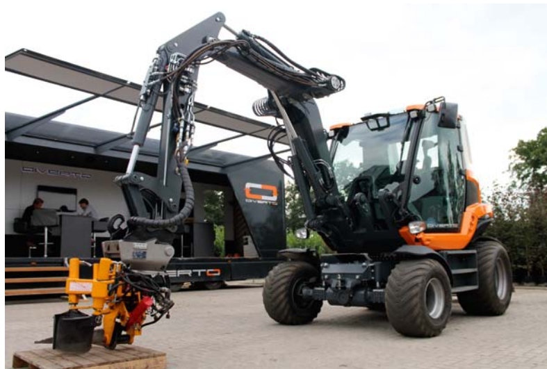
Drie machines in één Diverto: tractor, wiellader en graafmachine.
