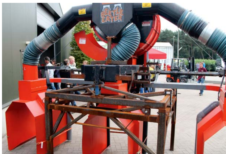
Deze versie voor aspergeteelt blaast wel voldoende om aspergekevers los te maken.
