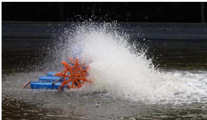
De Paddlewheel is feitelijk gewoon een vast schoepenrad in het water.
