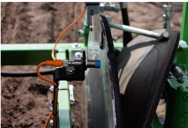
Sensoren langs de plantschijven geven exact de plantplaatsen aan.
